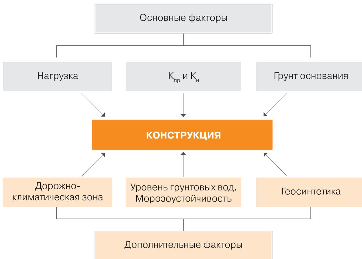
**Рисунок 12.** Факторы, определяющие вид конструкции
